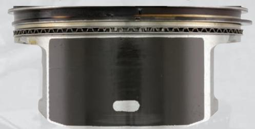
**Después de 250 horas (13,647 millas) de prueba dinámicas, el Aceite Sintético 20W-50 para Motocicletas V-Twin de AMSOIL protegió contra el rayado de pistón y el desgaste para una larga vida del motor.**
